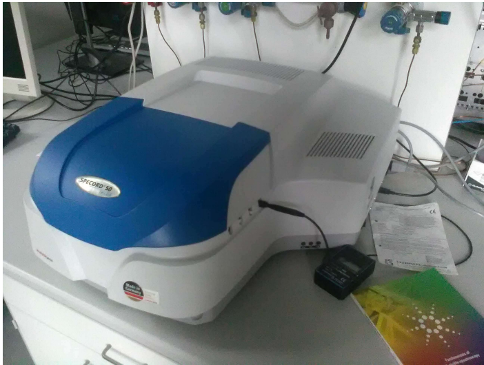
UV/Vis-Gerät im Praktikum
